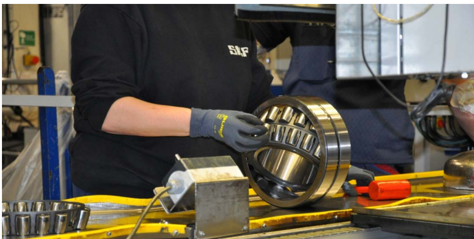
Figur 2. Iläggning av de sista rullarna som skall bankas i med gummi-klubban innan inneringen roteras på plats i ytterringen.
