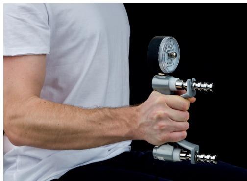
Figur. Mätning av handgreppsstyrka med hydraulisk handdynamometer Jamar®
